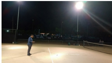
Fig. 5. Uno de nuestros técnicos en el proceso de levantamiento de información con el dispositivo de mando bluetooth. En la foto se muestra el proceso captura de iluminación en uno de los puntos de mayor incidencia de luz por parte de una de las lámparas. Se observa además el espectrofotómetro a nivel del suelo.
